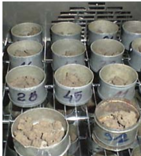
Слика 1. Следење на влагата во почвата со земање почвени проби и сушење (Чукалиев и Танасковиќ, 2007)
