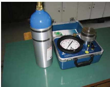
Слика 6. Комора под притисок „pressure chamber“ (извор Чукалиев и Танасковиќ, 2006)
