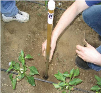
Слика 10 . Поставување на тензиометар на постојано место (на поле) (извор, Чукалиев и Танасковиќ, 2007)
