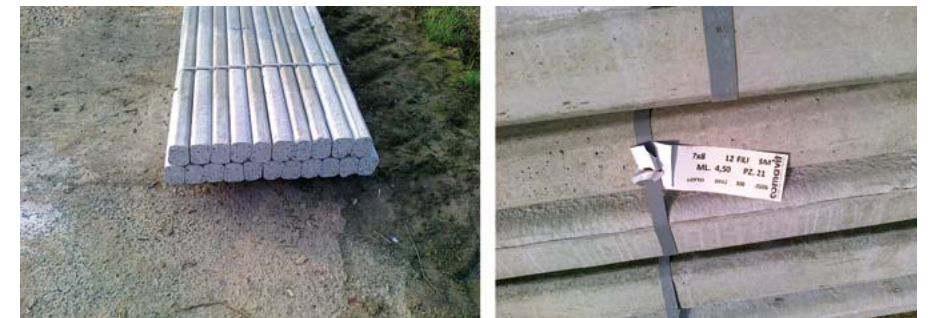
Сл. 23. Бетонски столбови за потпорна конструкција
